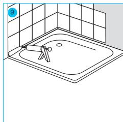
9 Die Fliesen mit einem Abstand von ca. 5 mm OK-Wannenrand aufbringen. Nach dem Fliesen in die entstandene Fuge ein Fugenhinterfüllprofil (Rundschnur) einlegen und anschliessend mit Sanitär silikon ausfügen.
