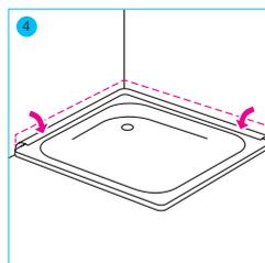
4 Wanne standfest montieren / Ablauf anschliessen. (Dichtigkeitskontrolle) Wannendichtband herunter legen.
