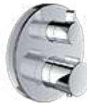
2-Griff-Fertigmontageset für thermostatischen Unterputz-Bademischer, mit 2-Wege-Mengenregulierung / mit integriertem Rohrunterbrecher
