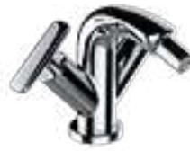
2-Griff Bidetmischer, Ausladung 105 mm, Festauslauf, mit Ablaufventil
