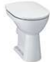
Stand-WC ‚comfort‘, Flachspüler, mit Spülrand, Abgang waagrecht / senkrecht, Sitzhöhe (inkl. Sitzring) 48 cm
